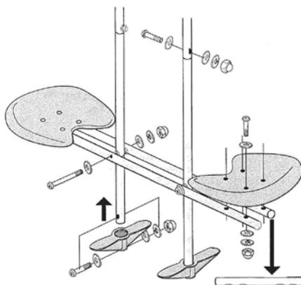
Выемки на трубке сиденья качелей (Y) должны быть снизу.
